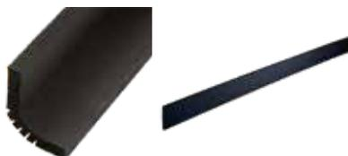
立上り防水層を、押えコンクリートの挙動から保護する発泡ポリエチレン製緩衝材。裏が粘着面で、立上り際の下地になじむよう切込み入り。
