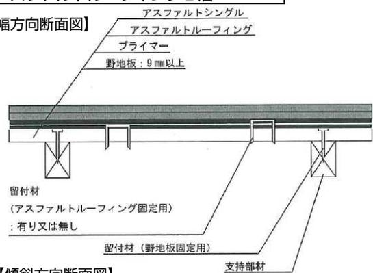
【傾斜方向断面図】
