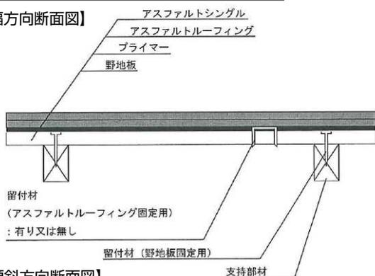
【傾斜方向断面図】
